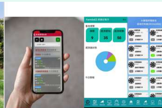
圖2.手機監控蛋雞舍狀態並可啟動變頻風扇支數及速度
