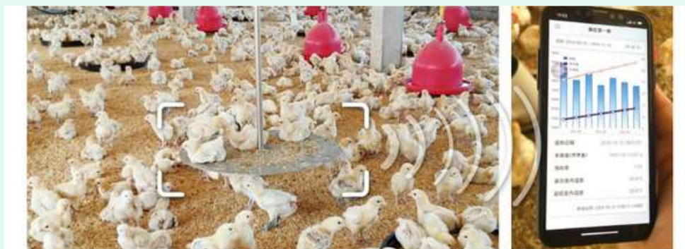
透過手機APP隨時監控智慧化禽舍各項感測器傳輸的數據，本圖示意雞隻秤重器傳輸數據後，於APP上呈現雞隻重量資訊。
