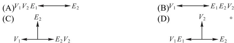
解 一、二次側繞組應電勢  $E_1$ 、 $E_2$  與電源電壓  $V_1$  向量相差  $180^\circ$ ，次級線圈開路，端電壓  $V_2$  與  $E_2$  同相
